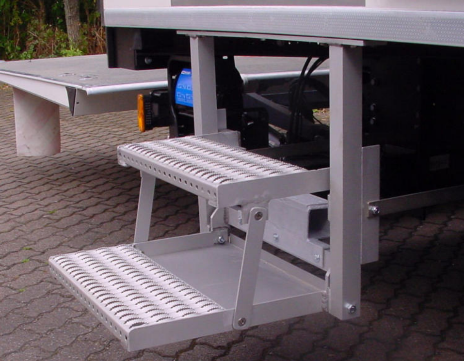
Mit Gewichtsverriegelung 8 kg, ohne zusätzliche Haken und Ösen. Nr. 559
