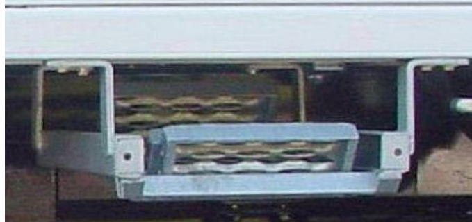
Gewichtsverriegelung, keine zusätzlichen Haken und Ösen.
