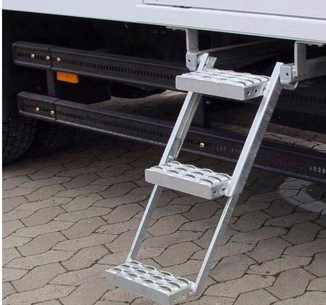
Gewichtsverriegelung, keine zusätzlichen Haken und Ösen.
