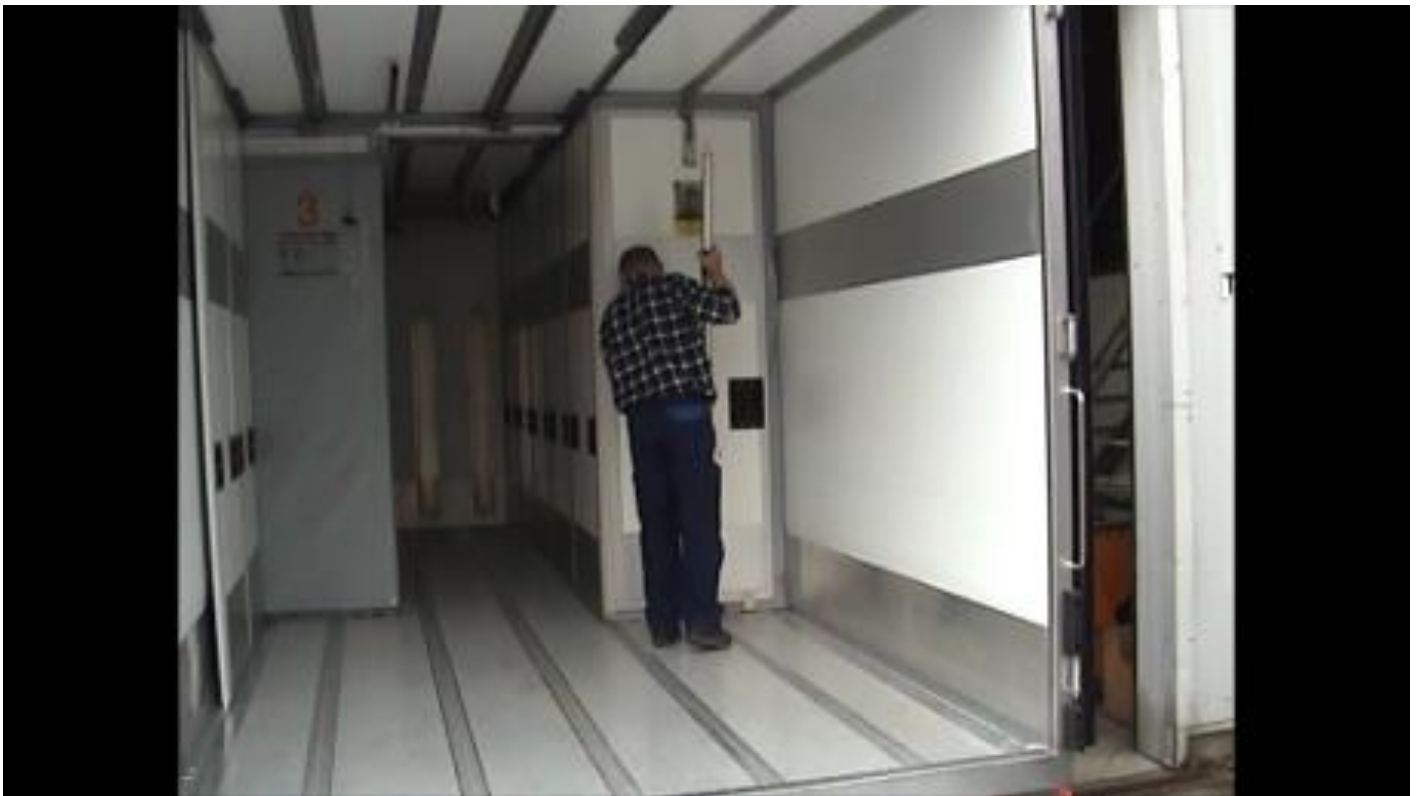
Wenn Ladung hinter der Segmenttür steht, bitte einen Sperrbalken vorsetzen.
