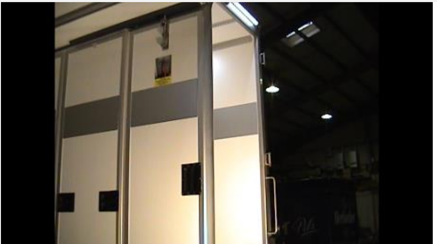
Wird die Tür in Längsstellung zwischen den Deckenschielen verriegelt, kann die gesamte Länge für TK oder Frische genutzt werden
