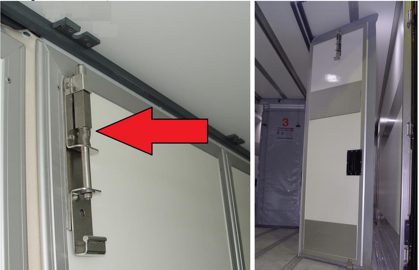
Nach dem lösen des Federriegels an der Innenwand, das letzte Element nach hinten ziehen.
