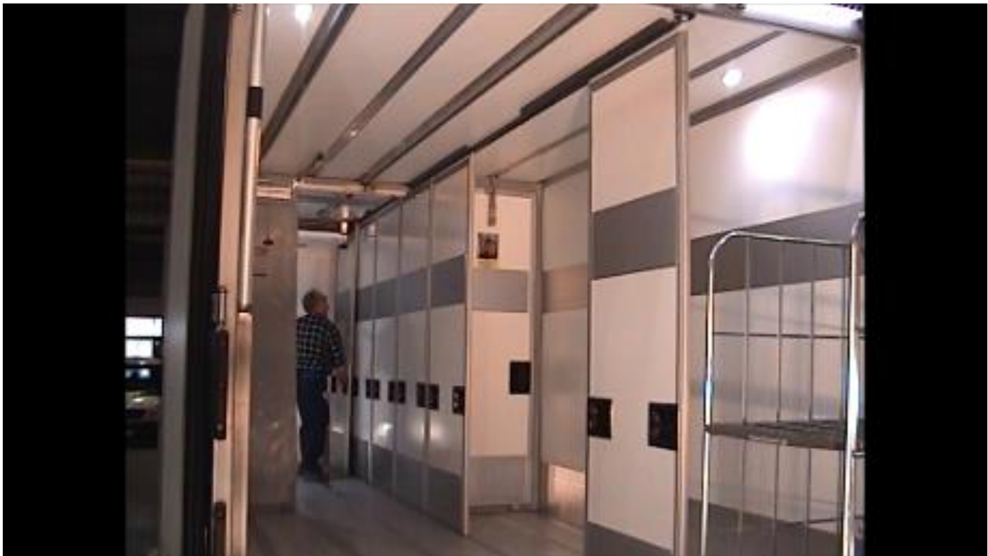
Die nach hinten geschobenen Segmentwände, werden über die Weiche, hinter der Trennwandtür, in die Hauptschiene geführt, dann ist die gesamte linke und rechte Kammer wieder palettenbreit. Die Segmentwände dienen zur Leergutsicherung, oder auch zur seitlichen Vollgutsicherung. Ob Paletten oder Rolli ist gleich.
