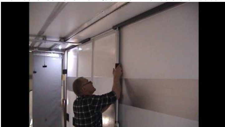
Damit die Wände beim Bremsen nicht vorrutschen können, werden sie mit einem Klemmbalken gesichert. Die entsprechenden Löcher sind vorhanden.
