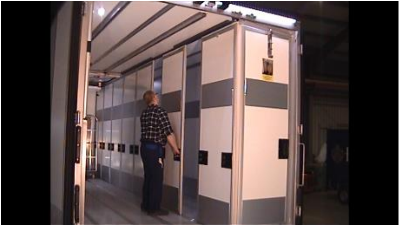
Das Element bis zur ersten Weiche schieben, kurz bis zur nächsten Schiene auskippen , anheben und in der zweiten Schiene nach vorn schieben.
