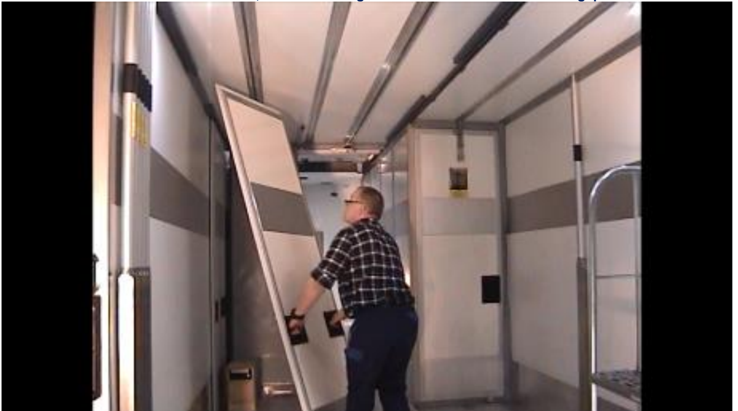
Die Deckenschienen für Quer-Trennwände stören dabei nicht mehr, die sind seit Mai 2018 in dem Dach versenkt.
