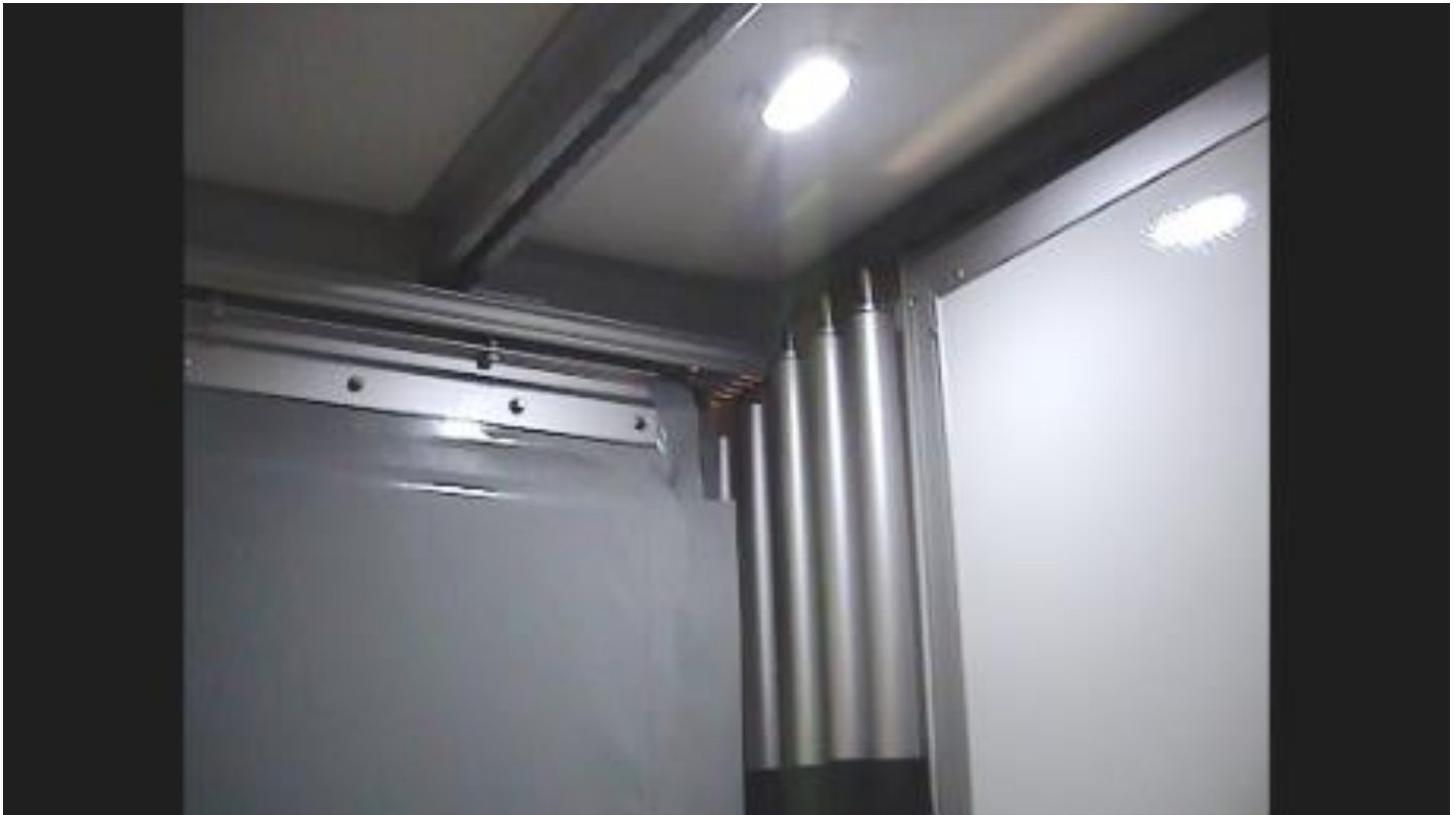
Bei Coolslide Vorhänge, die nach vorn verschiebbar sind, wird der Laufwagen des Vorhangs, so gekürzt, das er über die parkenden Sperrstangen und Segmente hinweg fahren kann.
