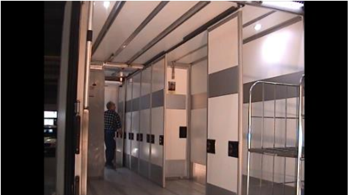
Wenn nicht vorn links Paletten gefahren werden müssen, sondern Rollbehälter, können die Segmente dort geparkt werden.
