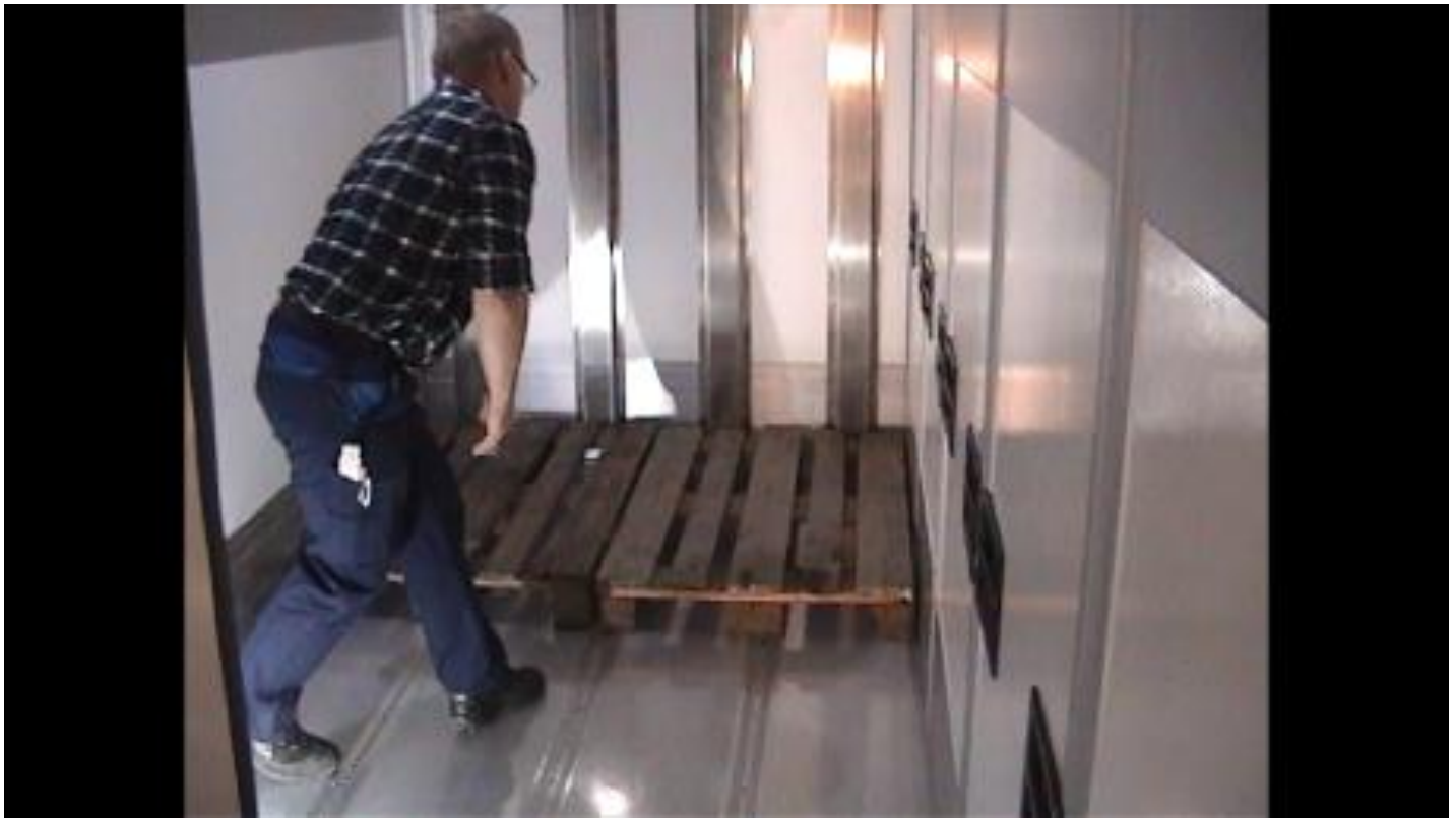
Wird eine Teilladung mit TK und gleichzeitig daneben 2 Paletten längs gefahren, müssen die geparkten Trennwände nach hinten geschoben werden, dann ist die vordere Breite wieder voll nutzbar. (Wie auf Foto)
