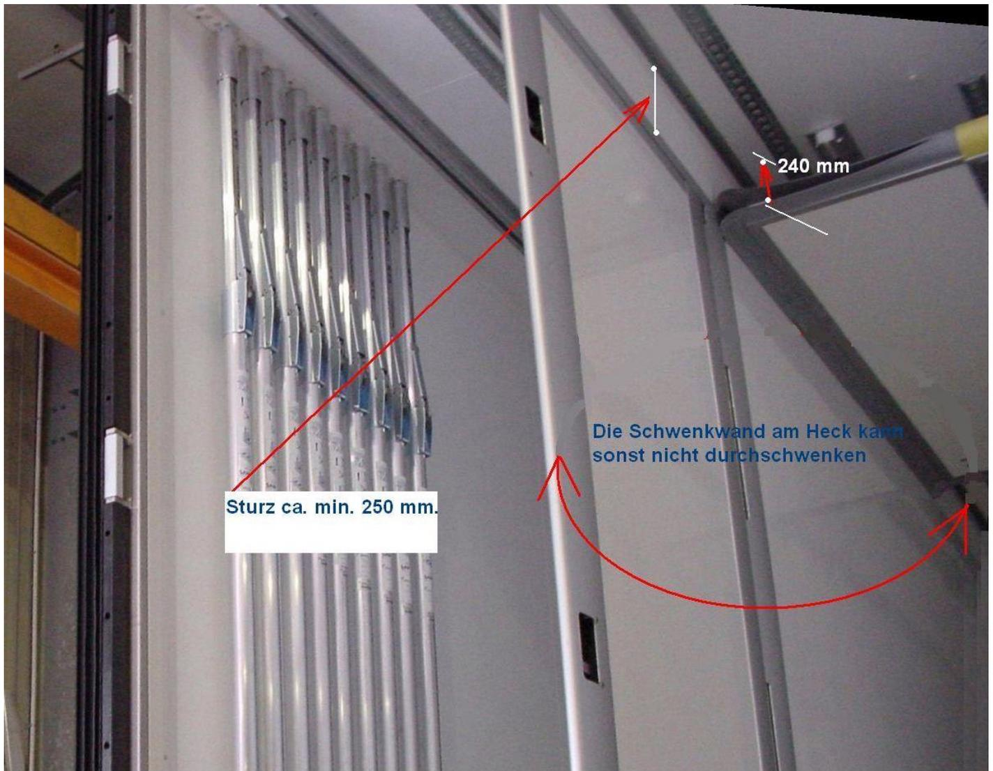
*Bei der Schwenkwand, sowie bei den Segment – Trennwand - Elementen, müssen unten im Boden Airline Schienen vorgesehen werden.*
