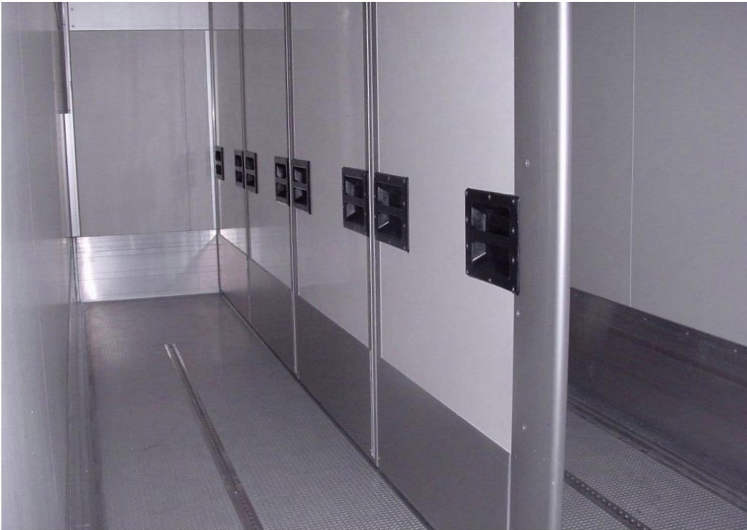
***Das Abschlussprofil muss immer mit einem Verschluss ausgerüstet sein die Wände wandern sonst nach hinten.***
