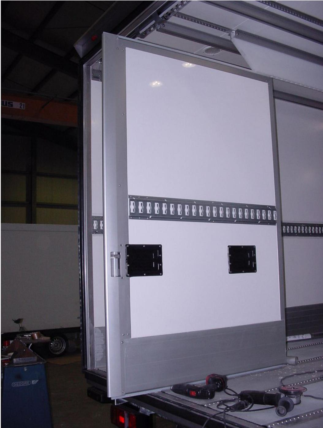
*Wenn rausziehbar, eine Airline-Schiene auch oben, oder einen Sturz aus PE mit Führung.*
