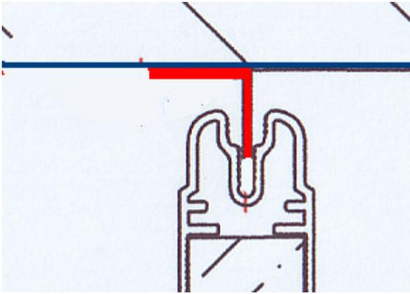
*Wenn raus hebbar, bekommt die Wand oben eine 30 x30 x 3 mm Winkelschiene.*
