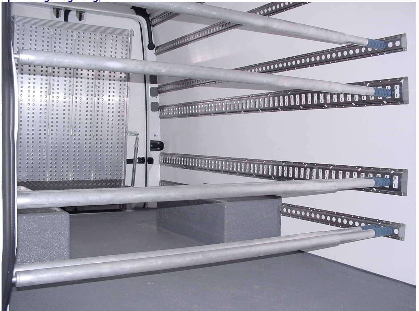
Alle Innenbreiten von unten bis oben werden abgedeckt.
