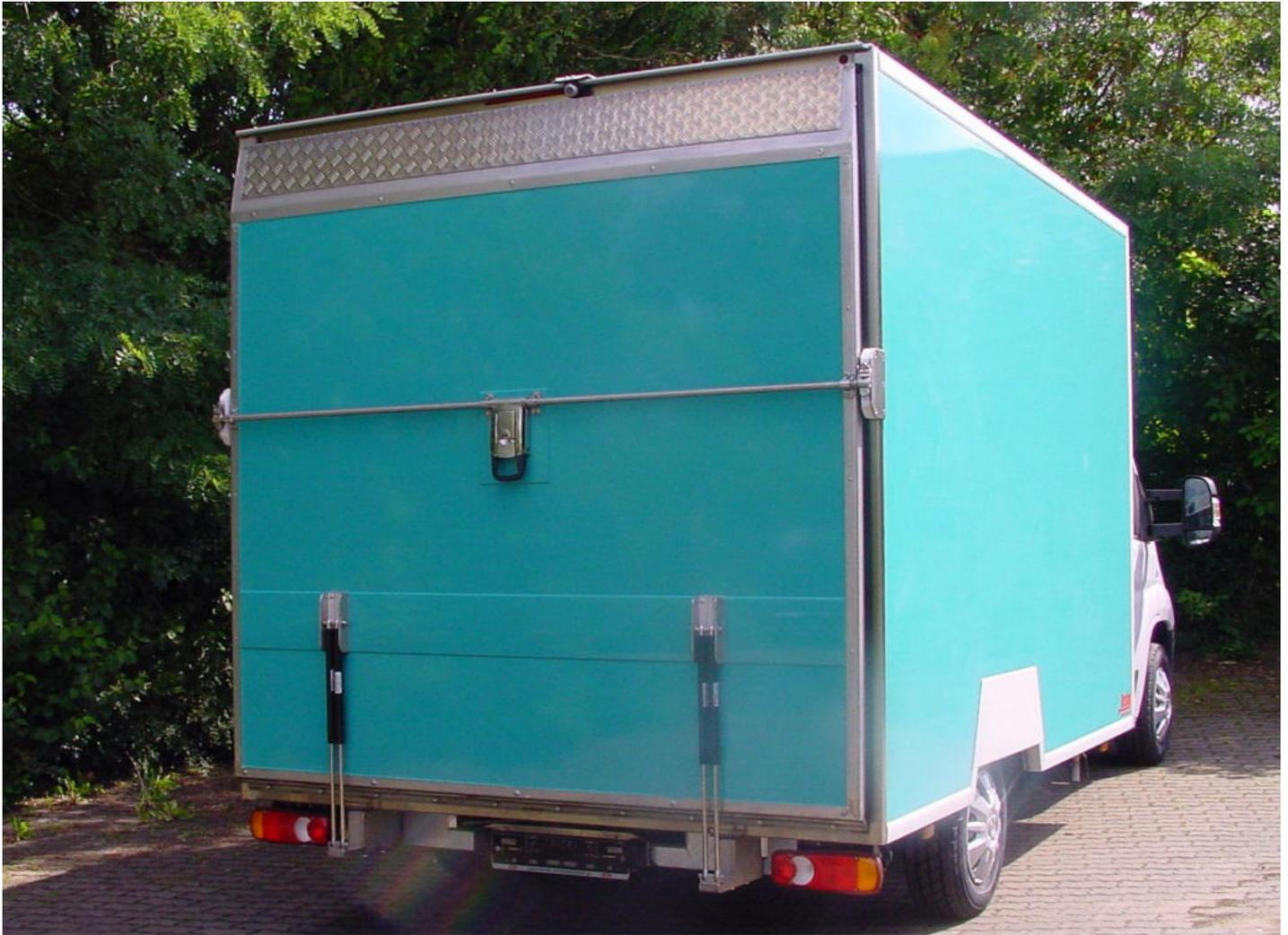
Auch diese Rampe ist, wie alle Exterpol Rampen, komplett neutral, gewichtsentslastet. Alle Gasdruckfedern werden in der rostfreien VA Ausführung eingesetzt.
