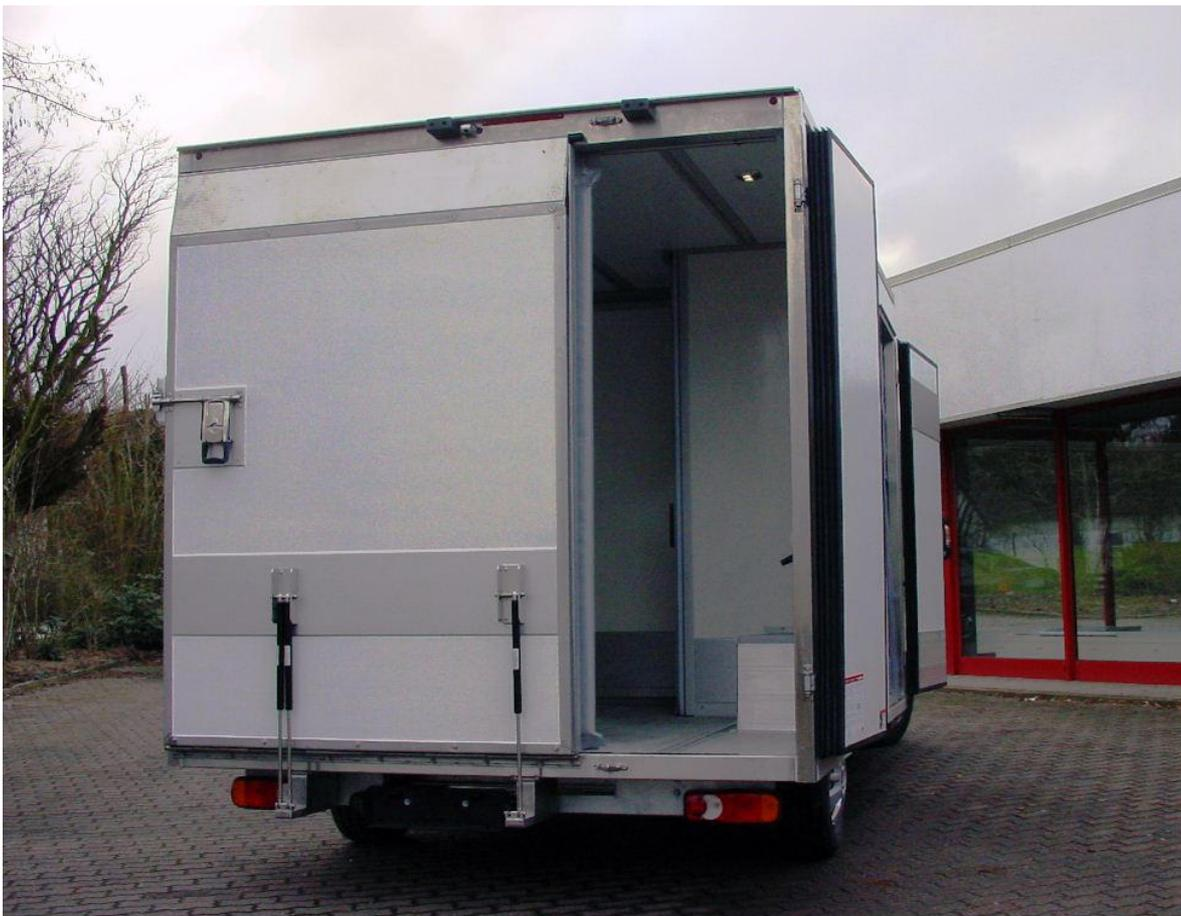
**2/3 Laderampe, Polyester Wabenplatte mit Tragkraft 350 kg Klappengewicht 85 kg Klappenstärke 50 mm VA Scharnier und VA Zunge mit VA Seitenprofilen verschweißt, rutschfeste Beschichtung.**
