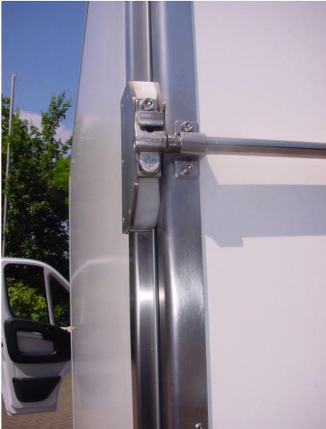
Die Klappe wird rechts und links in abgeschrägte Nylonblöcke eingeführt.
