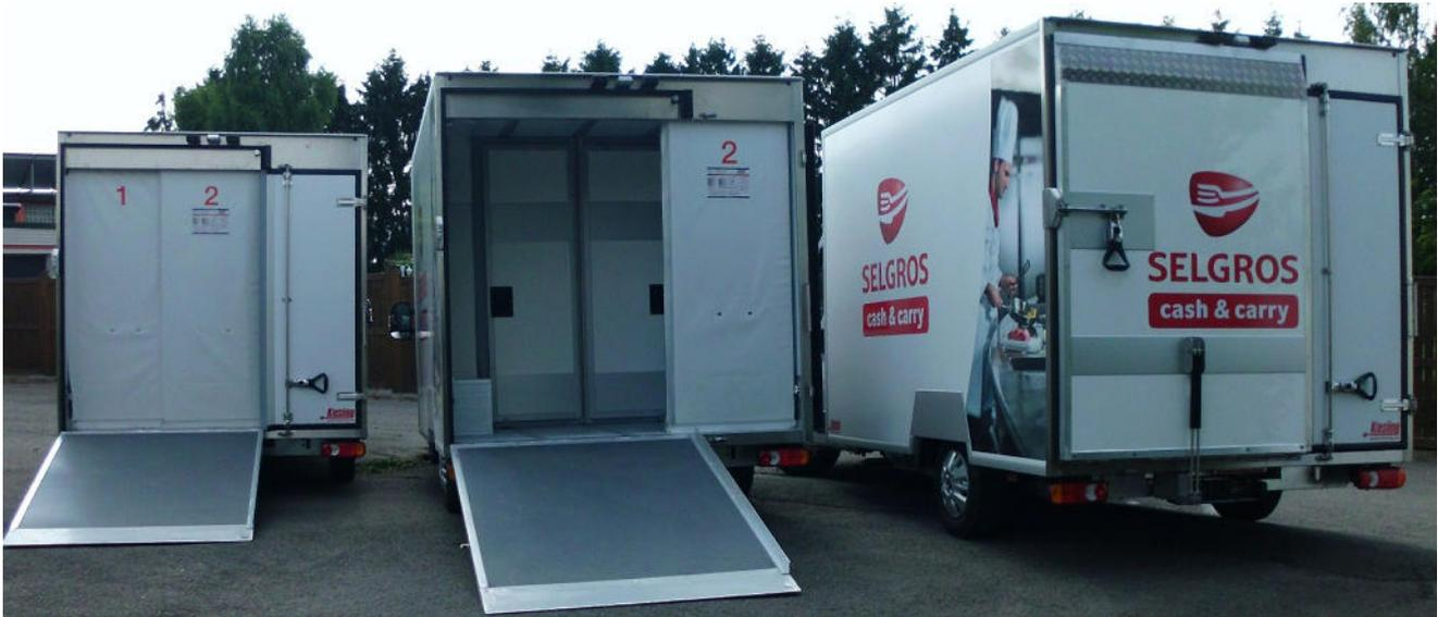
Alle Rampen mit daneben befindlichen Türen lassen sich unabhängig von der jeweiligen Tür, öffnen und schließen, ebenso die Tür unabhängig von der Rampe. 65 mm lange Silikondichtungen, reißfest und mit hoher Lebensdauer, machen das möglich.
